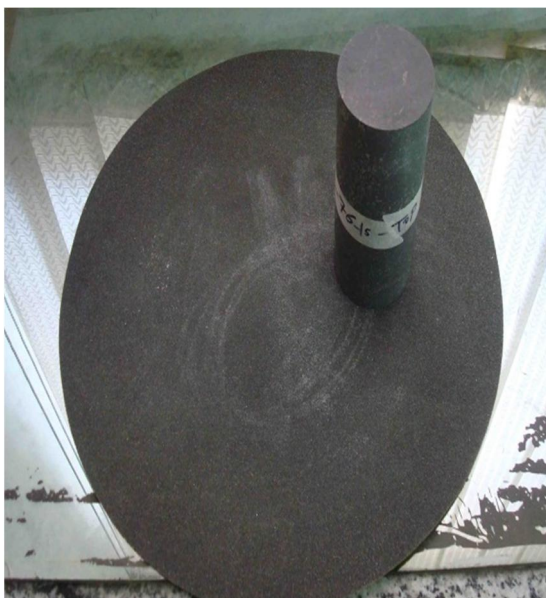
شکل ۴-۶- نحوه آماده سازی نمونه برای آزمایش مقاومت فشاری تک محوری و سرعت صوت
