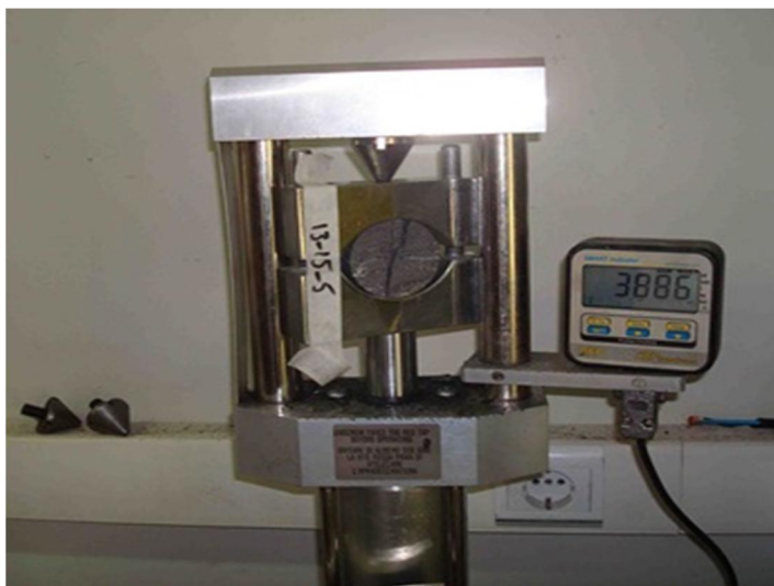
شکل ۴-۸- نمایش از آزمایش مقاومت کششی برزیلی در لحظه شکست
