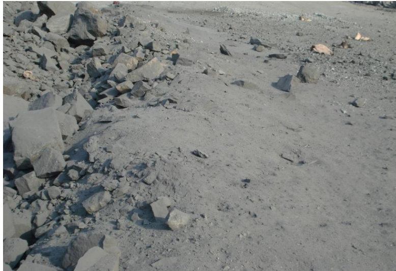
شکل (۴-۱۶): آتشکاری پیش‌شکاف آزمایش اول بدون اثری از عقب‌زدگی در پشت دیواره پیش‌شکاف
