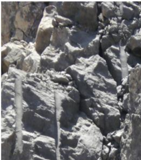
شکل (۴-۱۱): مشاهده نیم چال های باقی مانده روی دیواره پیش شکاف آزمایش اول
