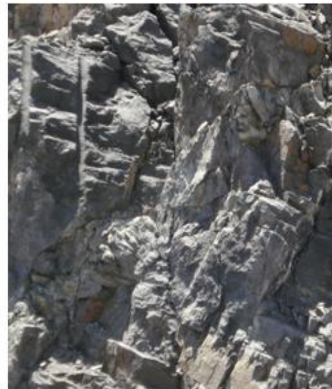
شکل (۴-۱۱): مشاهده نیم چال های باقی مانده روی دیواره پیش شکاف آزمایش اول
