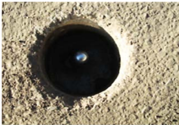
شکل ۲-۳- پین نشست سنج نصب شده در سطح خیابان (شرکت تونل راد، ۱۳۸۹)
