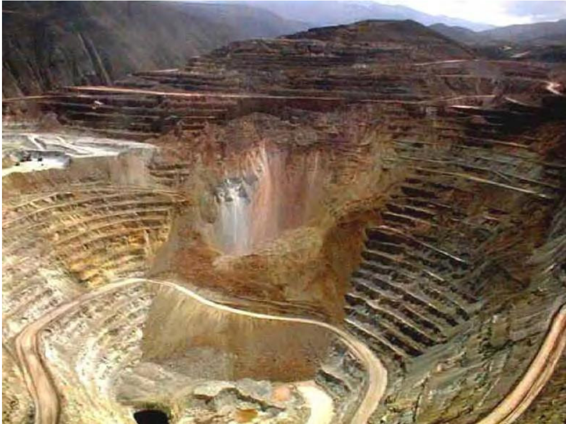
شکل ۱-۴- شکست شیب بزرگ مقیاس در یک معدن مس پورفیری در آفریقای جنوبی ( Hoek et al., 2000a)
