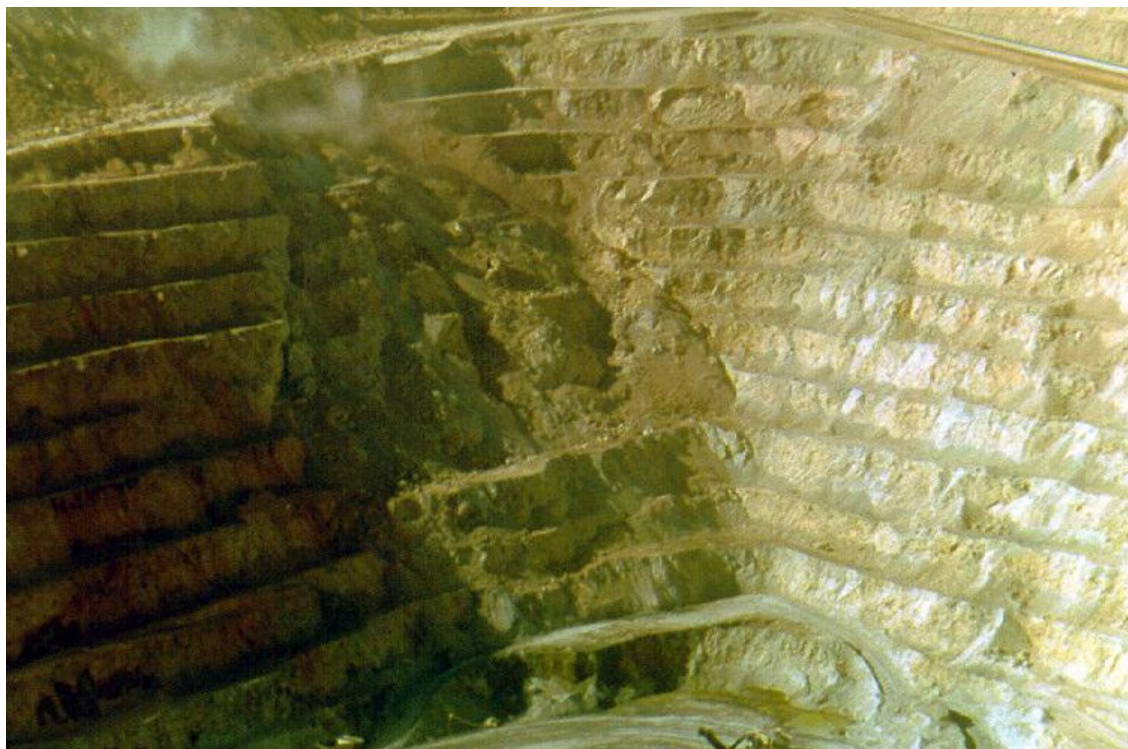
شکل ۲-۱۰- نمونه‌ای از یک شکست شیب بزرگ مقیاس با کنترل ساختاری بخشی و مکانیزم شکست تا حد زیاد ناشناخته (Hoek et al., 2000a)
