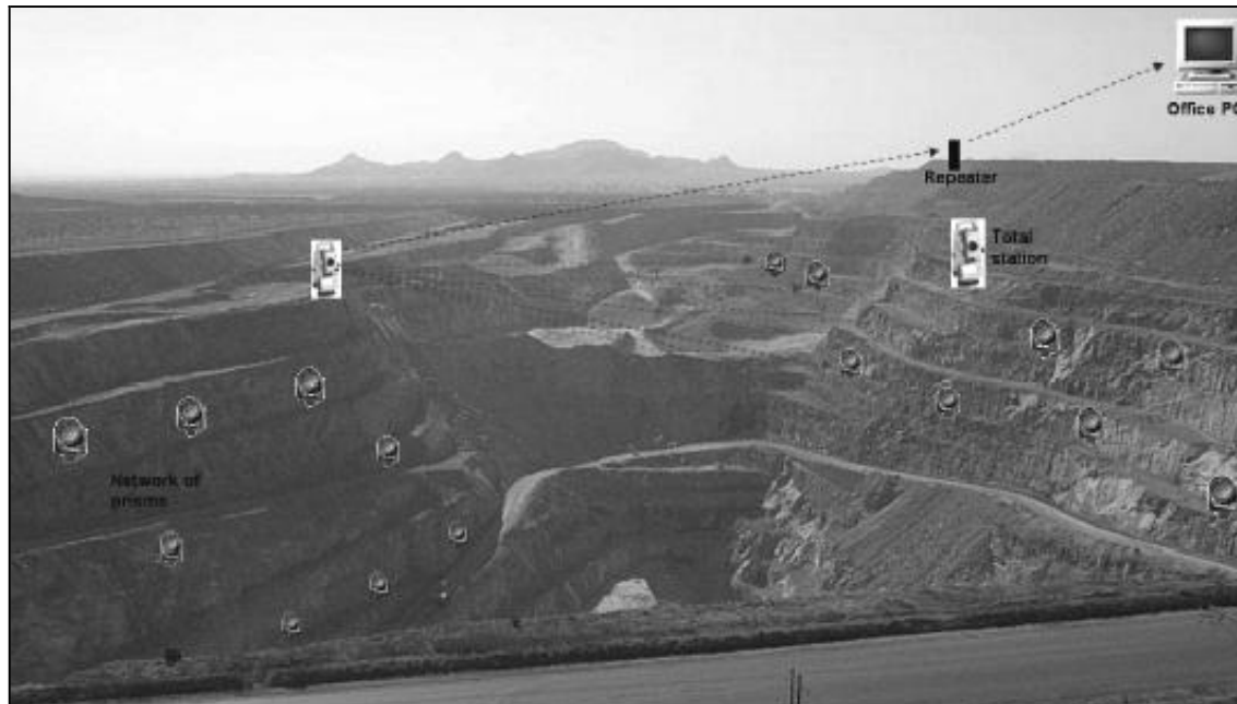
شکل ۲-۱۶- نمونه‌ای از جانمایی نصب تجهیزات SSR در معدن روباز Sandsloot در آفریقای جنوبی ( Little, 2007)
