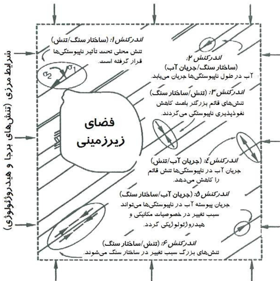
شکل ۳-۳- شش اندرکنش دوتایی میان ساختار سنگ، تنش‌ها در سنگ و جریان آب در اطراف یک فضای زیرزمینی (Hudson & Harrison, 1997)
