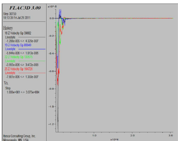
شکل ۵-۱۵- تاریخچه جابجایی چهار نقطه معلوم در کف غار
