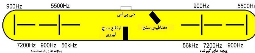
شکل (۳-۵): ساختار پیچه دیگهم [After Fugro, 2003]
