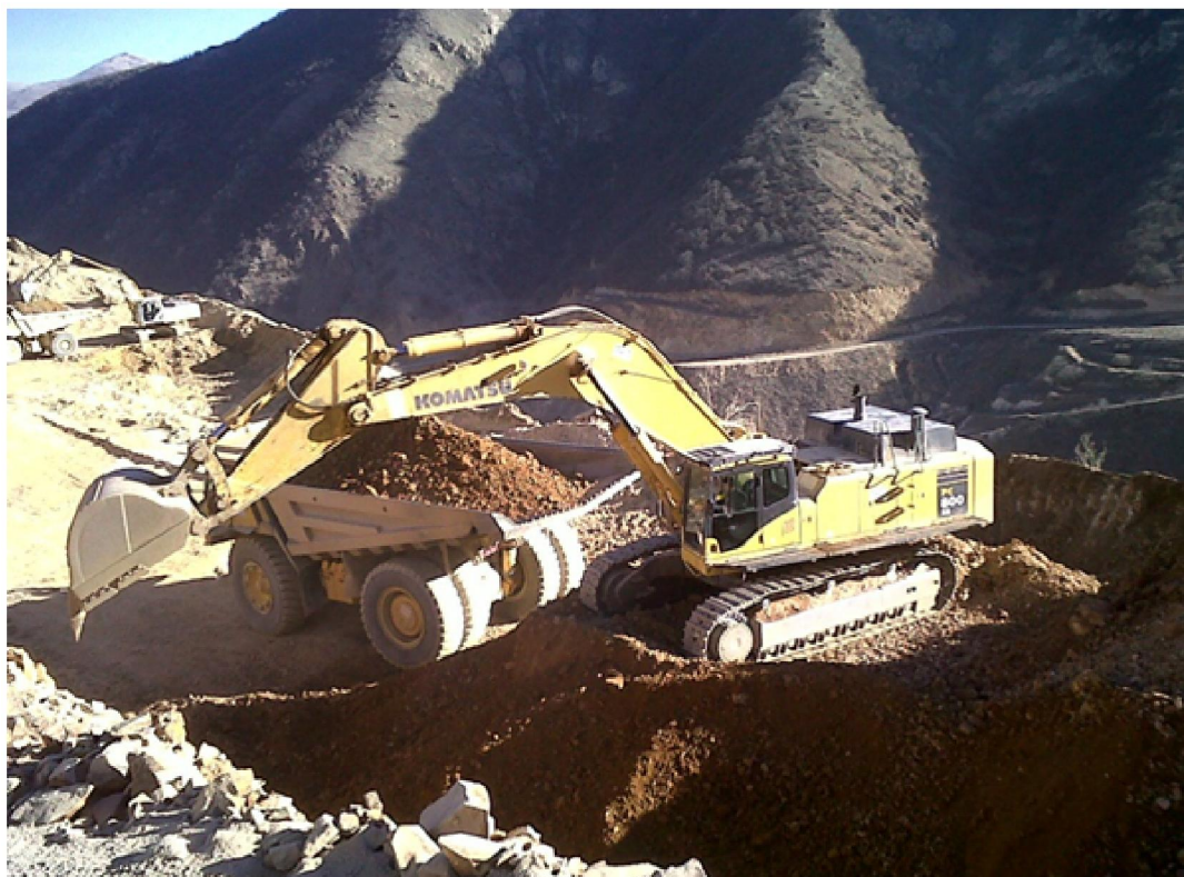
شکل ۳-۵ بارگیری و حمل توسط بیل مکانیکی و دامپ‌تراک ۱۰۰ تنی
