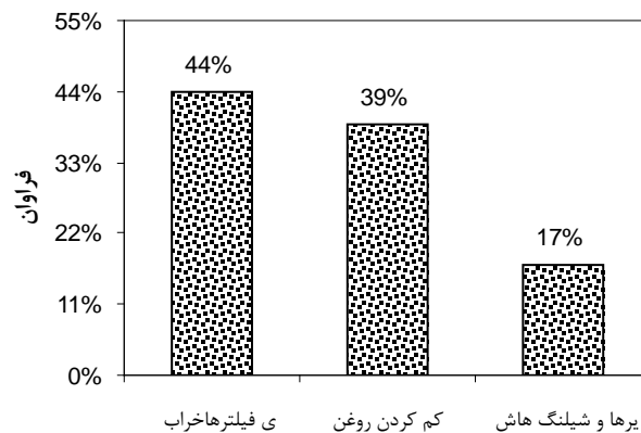
شکل 5-15- فراوانی مهمترین دلایل خرابی سیستم هیدرولیک شیرر
