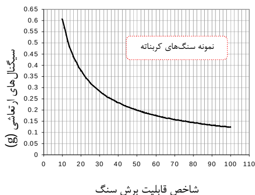
شکل 4-21- تغییرات سیگنال‌های ارتعاشی نسبت به شاخص قابلیت برش در شرایط ثابت عملیاتی برای سنگ‌های گرانیتی و کربناته
