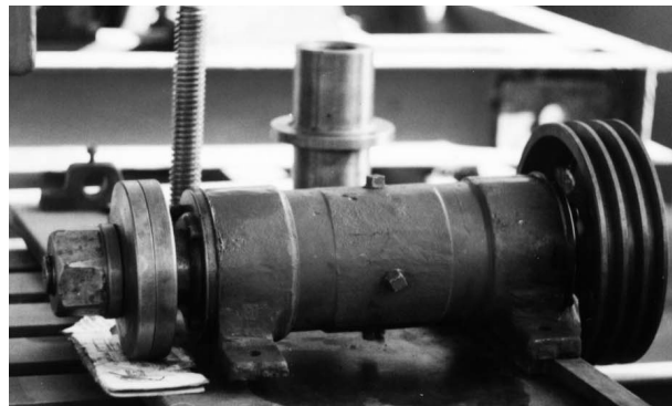
شکل 4-11- گلوئی دستگاه تست همراه با واشرهای چدنی برای بستن دیسک الماسی
