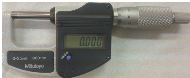
شکل 4-6- میکرومتر دیجیتالی برای اندازه‌گیری سایش ماکروسکوپی
