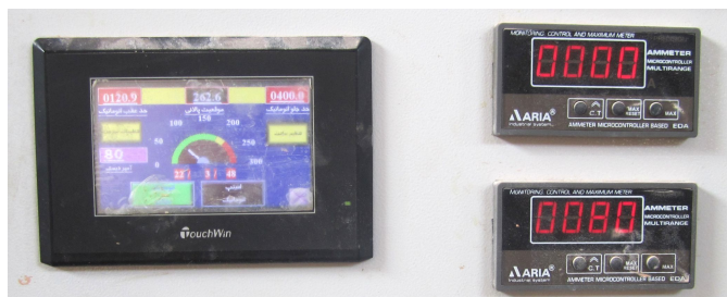
شکل 4-7- آمپرسنج مورد استفاده برای ثبت تغییرات شدت جریان مصرفی
