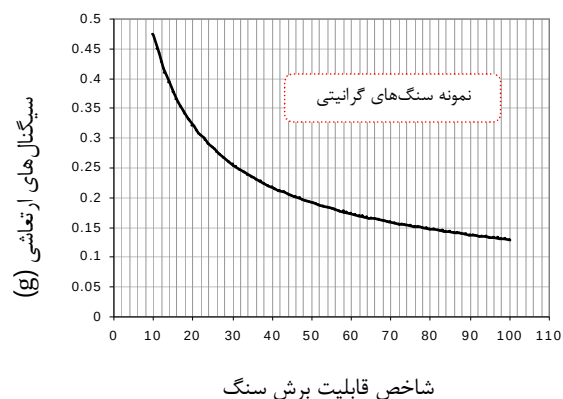
شکل 4-21- تغییرات سیگنال‌های ارتعاشی نسبت به شاخص قابلیت برش در شرایط ثابت عملیاتی برای سنگ‌های گرانیتی و کربناته
