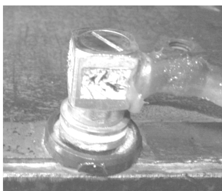
شکل 4-13- شتاب‌سنج مورد استفاده برای ثبت ارتعاش‌های سیستم
