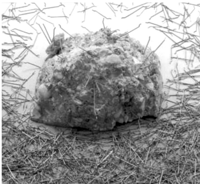
شکل (۶-۲): بتن پاشیده‌ی مسلح با الیاف فولادی (Kolymbas, 2008)
