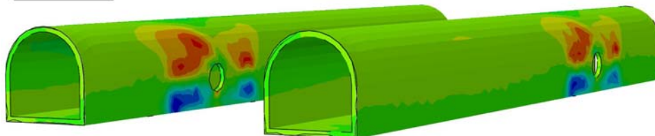
شکل ۶-۲۲ توزیع تنش برشی در پوشش بتنی
