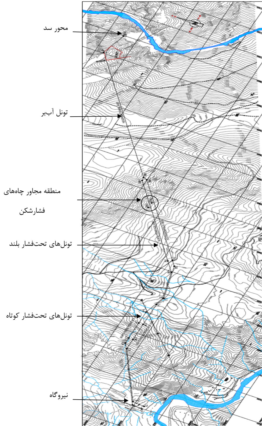
شکل ۴-۵ جانمایی بخش‌های مختلف تونل‌های آبرسان در پروژه رودبار
