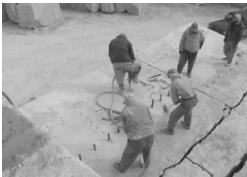
شکل ۲-۱- نمونه‌ای از کار با پارس و گوه (عطائی، ۱۳۸۷)
