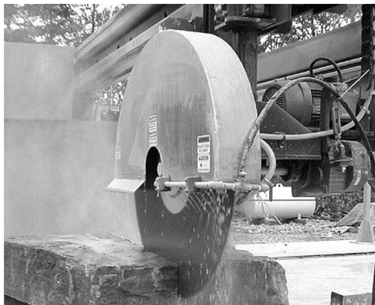
شکل ۲-۵- نمونه‌ای از قله‌بر (Process Development & Fabrication website)
