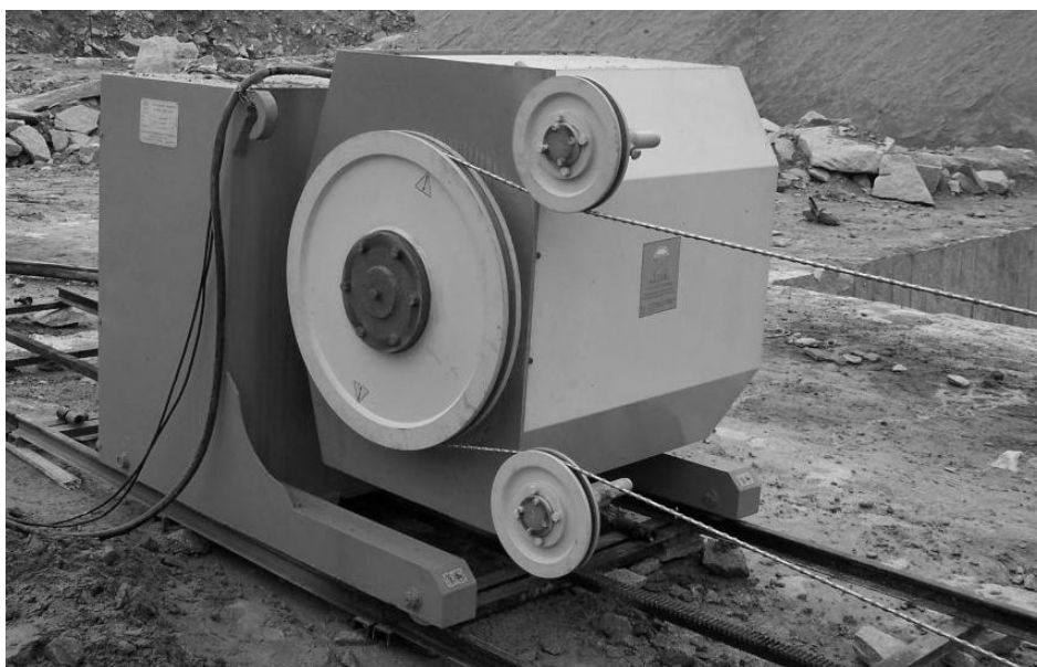
شکل ۲-۳- نمونه‌ای از ماشین استخراج با استفاده از سیم برش (Global Stone B rB Marketplace)
