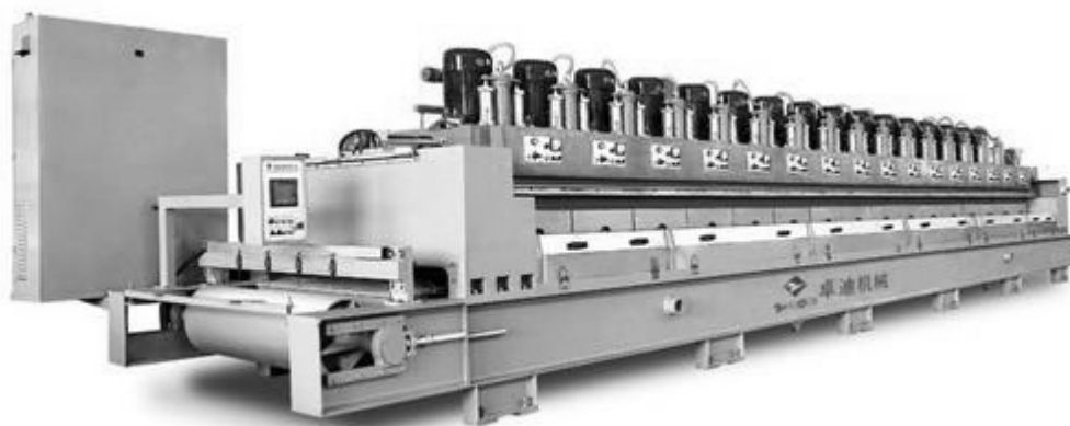
شکل ۲-۷- نمایی از دستگاه ساب در فرآوری سنگ (Guangdong Zhuodi Machinery Co. website)
