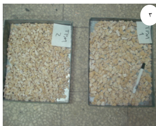
شکل ۳-۶: مراحل کار در انجام آزمایش لوس آنجلس
