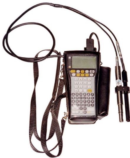
شکل ۱-۴- نمایی از ابزار اندازه‌گیری H_2S مجهز به ریزحسگر ( www.amt-gmbh.com )
