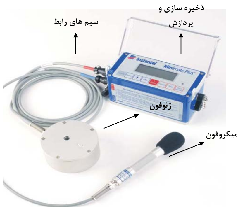
شکل ۳-۴- بخشهای مختلف دستگاه لرزش سنج Minimate Plus
