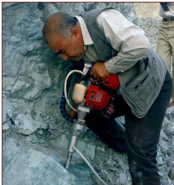
شکل 4-7 دستگاه مغزه گیر دستی و قابل حمل جهت مغزه گیری
