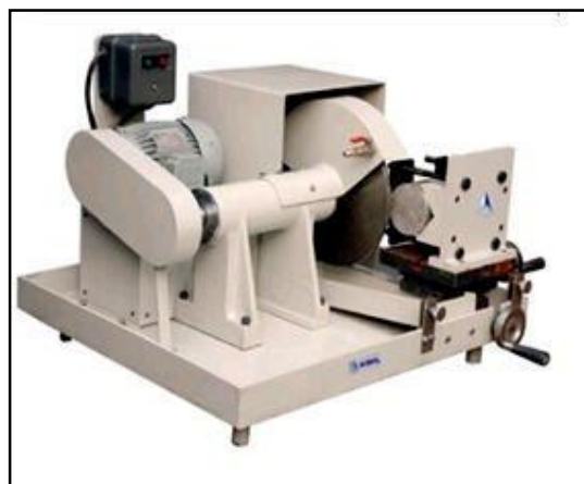
شکل 12-4 دستگاه برش مغزه واقع در آزمایشگاه تهیه ی مقطع
