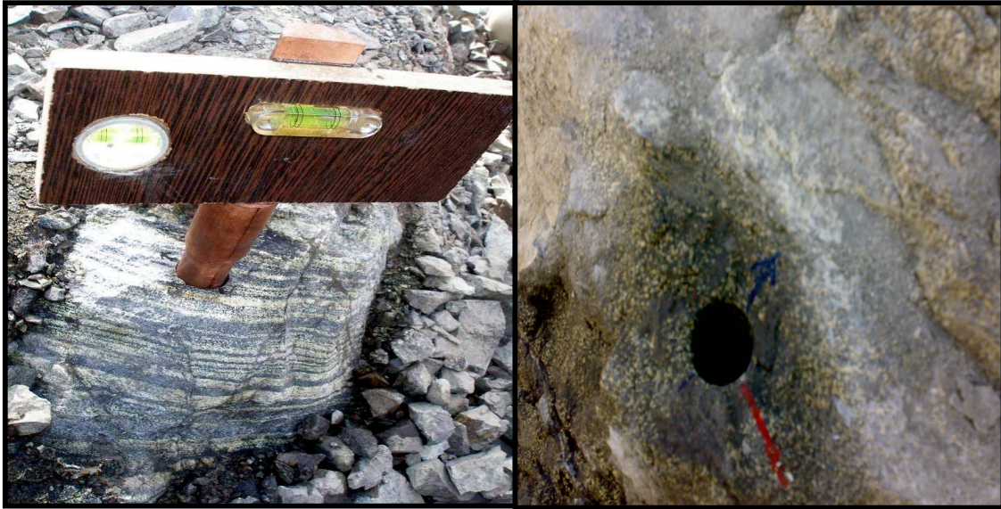
شکل 9-4 ابزار طراحی شده برای ثبت شیب و جهت جغرافیایی مغزه در محل نمونه گیری
