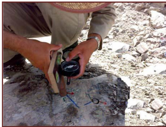
شکل 10-4 ثبت شیب و جهت جغرافیایی قرارگیری مغزه در محل نمونه برداری
