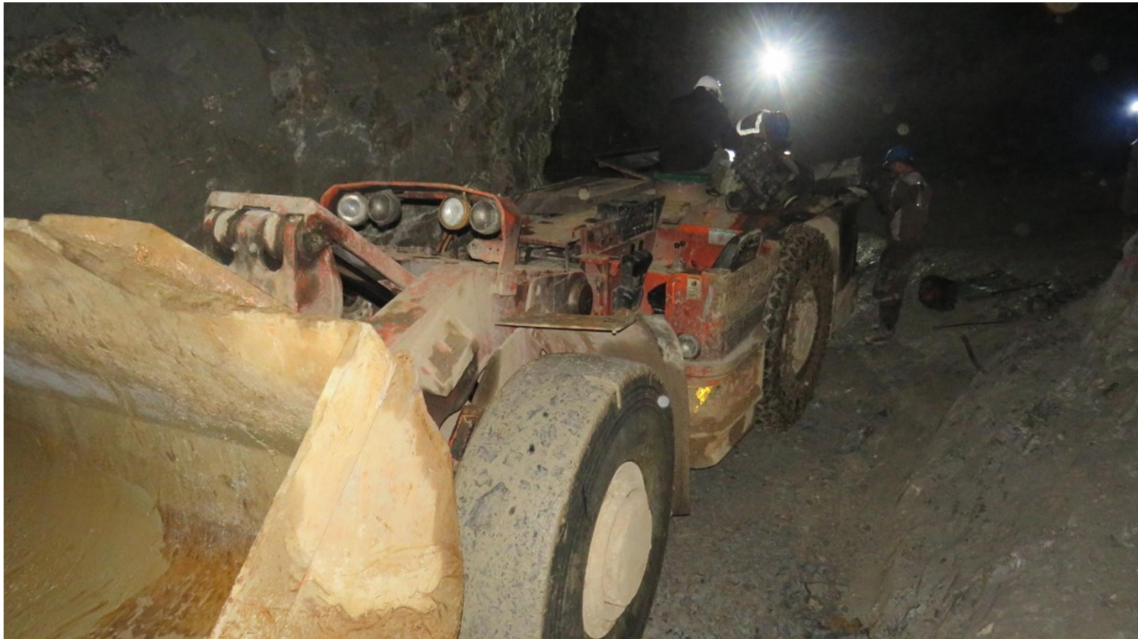
شکل ۳-۴: LHD مورد استفاده در معدن برای بارگیری و باربری
