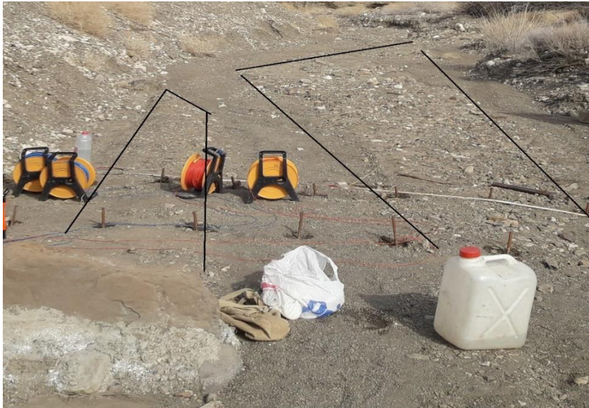
شکل ۴-۱۴. آبرفت‌های درشت‌دانه که در جهت عمود بر امتداد پروفیل‌ها باعث ایجاد مقاومت الکتریکی بالا شده است.
