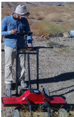
شکل ۴-۲۳. دستگاه Cbra plug_in با آنتن ۱۵۰ مگاهرتز
