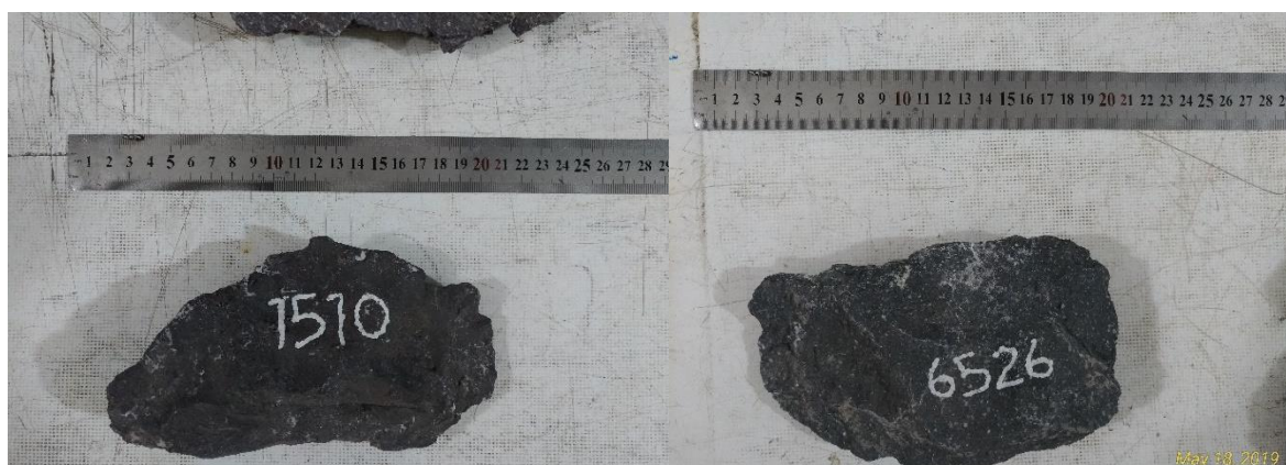
شکل ۶-۱: نمونه‌های سنگ برای انجام آزمایش نفوذ پانچ در تونل انتقال آب کرمان
