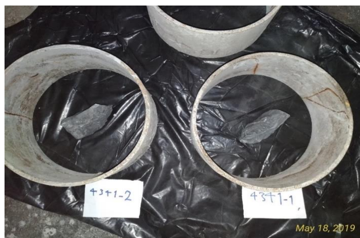
شکل ۶-۲: قرار گرفتن نمونه‌ها در مرکز قالب
