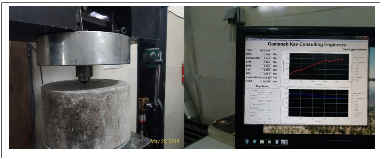
شکل ۶-۳: قرارگیری پانچ بر روی سطح نمونه سنگ و ثبت تغییرات نیرو و نفوذ
