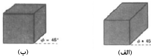
شکل ۸-۲ - تصویر یک مکعب با \phi = 45 ، (الف): تصویرسازی کوالیر، (ب): تصویرسازی کابینت [فولی و همکاران، ۱۹۹۶]
