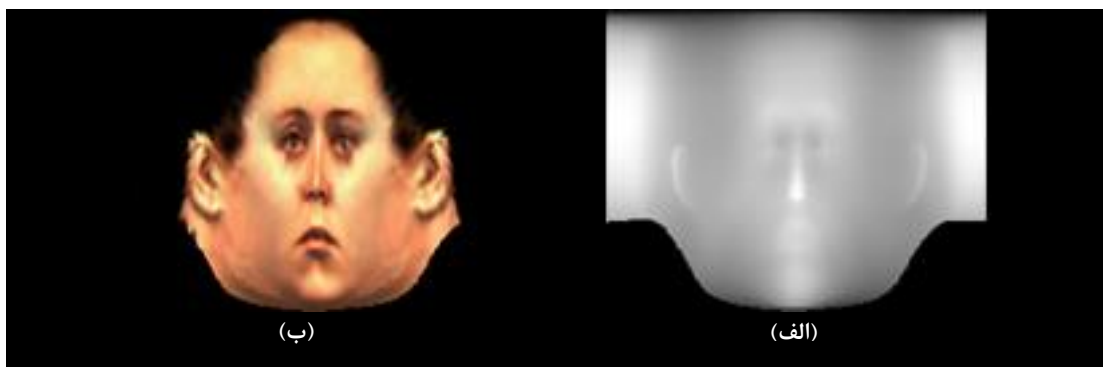
شکل ۳-۱ - تصاویر سه بعدی چهره شماره ۵ در دستگاه مختصات استوانه‌ای توسط پوشگر لیزری [MPI]، (الف): تصویر عمق، (ب): تصویر بافت
