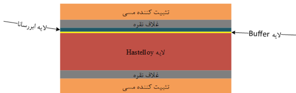
شکل ۲-۴ ساختار نوازی یک ابررسانای نسل دوم
