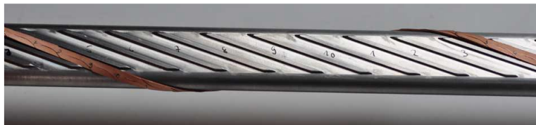
شکل ۸-۲ نحوه قرارگیری نوارهای ابررسانا به روش رادرفورد [۳۳]
