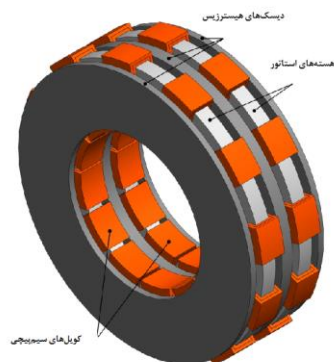
شکل ۲-۱۱: ساختار موتور هیستریزس تخت چند لایه بدون شیار [8]
