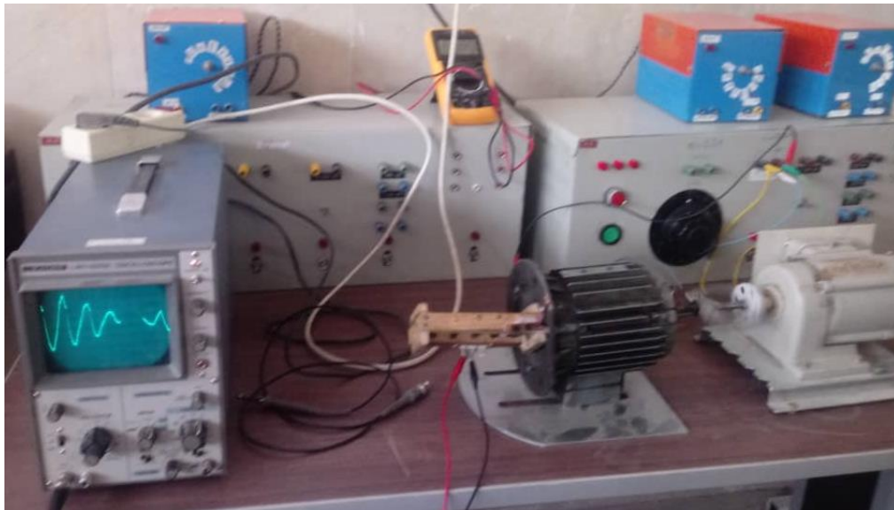
شکل(۵-۵): آزمایش موتور نمونه ۲۰ قطب ۲۴ شیار با منبع DC و گوپلینگ با موتور کمکی
