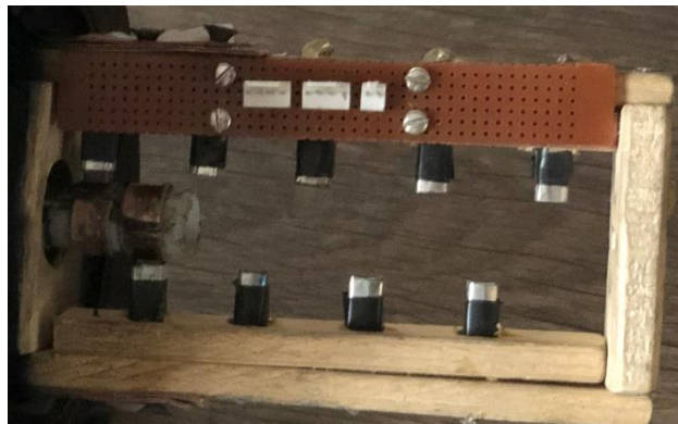
شکل (۵-۴): اسلپ رینگ روتور موتور نمونه ۲۰ قطب ۲۴ شیار
