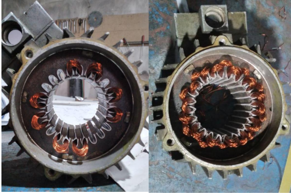
شکل (۵-۲): سیم پیچی استاتور موتور نمونه ۲۰ قطب ۲۴ شیار
