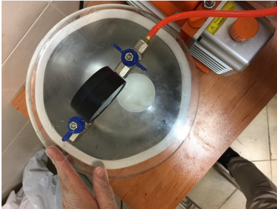
شکل (۵-۵) نحوه تخلیه گاز از سیلیکون را توسط پمپ خلأ
