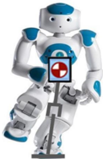
شکل (۸-۳) مدل پاندول معکوس خطی با چرخه دوار [۴۰].
