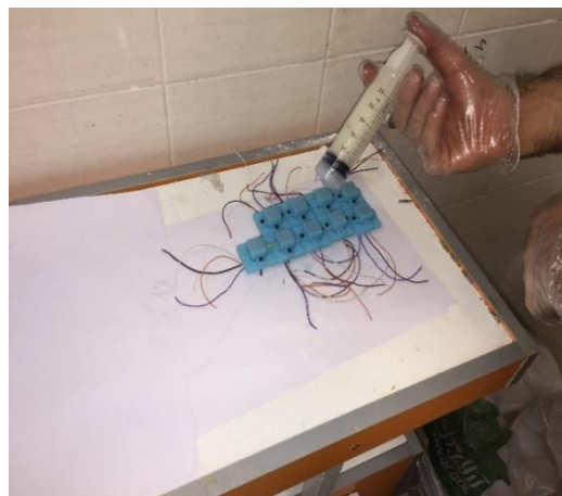
شکل (۶-۵) تزریق مخلوط سیلیکون و هاردنر در قالب
