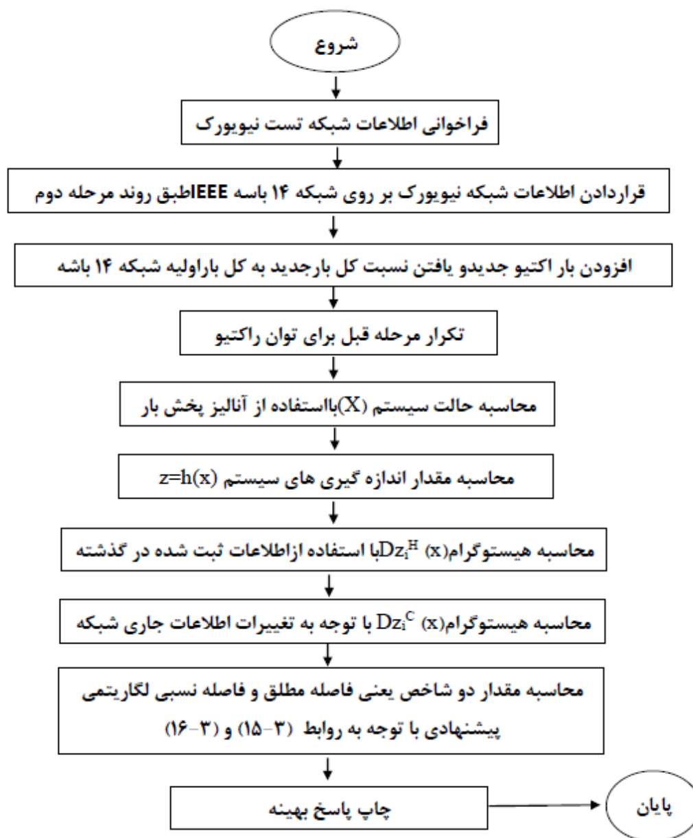
شکل ۴-۶- فلوچارت تولید داده‌های حالت سیستم از الگوی بار NYISO و همچنین نحوه شبیه‌سازی روش پیشنهادی
