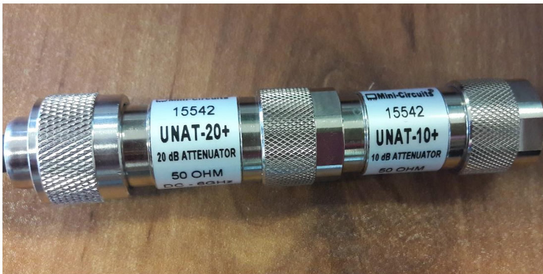
شکل (۳-۱۳) ۳۰dB تضعیف‌کننده به منظور ایجاد ایمنی برای تجهیز اندازه‌گیر
