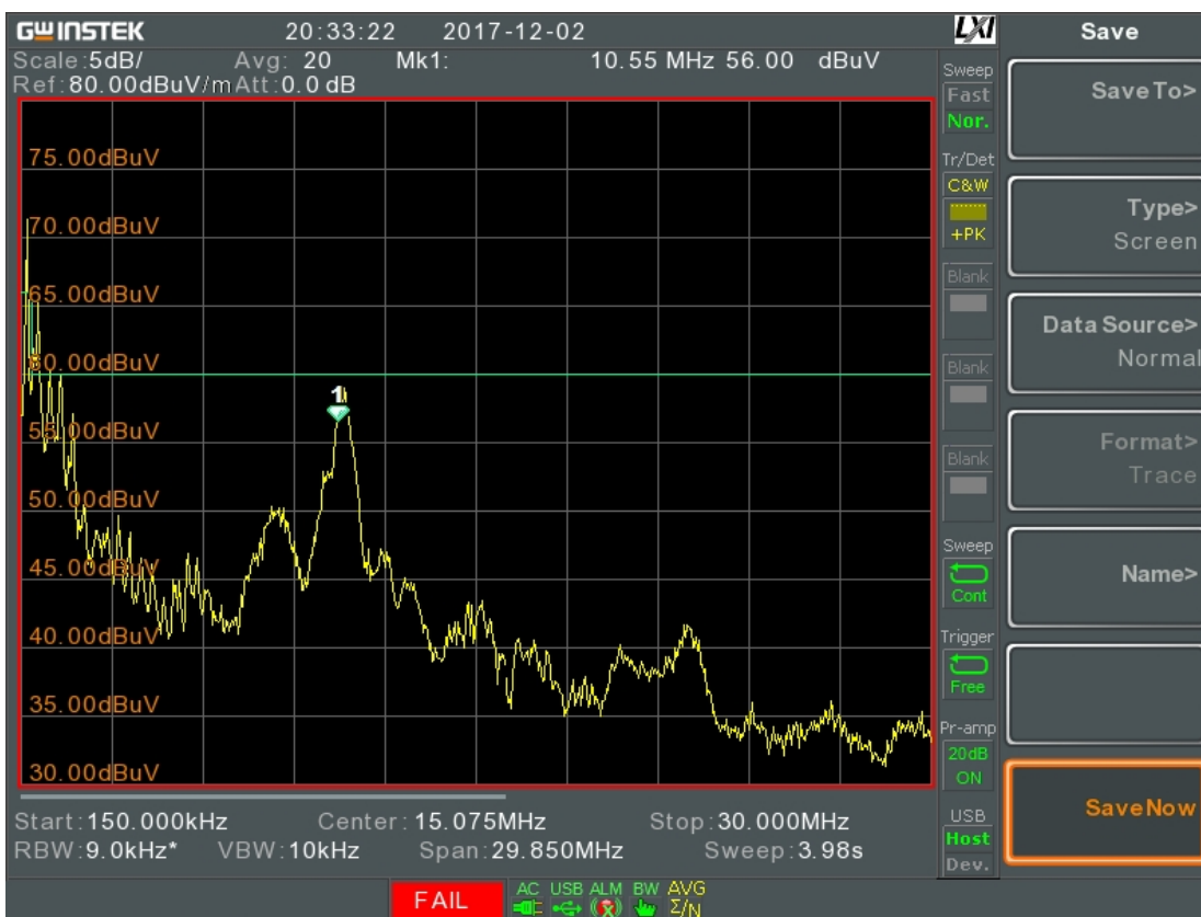
شکل (۳-۱۴) تصویر انتشار هدایتی مود مشترک اینورتر بر روی SA، در ضمن استفاده از 30dB تضعیف‌کننده و تحلیل میانگین جهت محاسبه انتشار هدایتی
