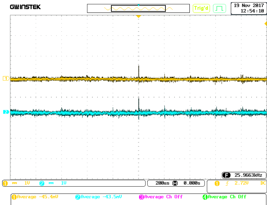
شکل (۴-۲۱) تصویر اسیلوسکوپ برای ولتاژ فاز و نول خروجی LISN با فیلتر
