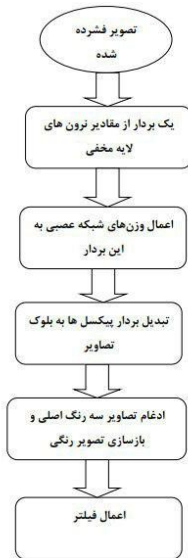
شکل ۴-۱) ب: بلوک دیاگرام روش پیشنهادی برای آموزش خودرمننگار در بازسازی تصویر
