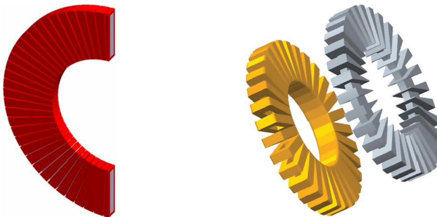
شکل ۱۱-۱: دو نمونه سیم‌پیچی استاتور ماشین تخت متشکل از کلاف‌هایی با محور موازی صفحه فاصله هوایی [۸].
