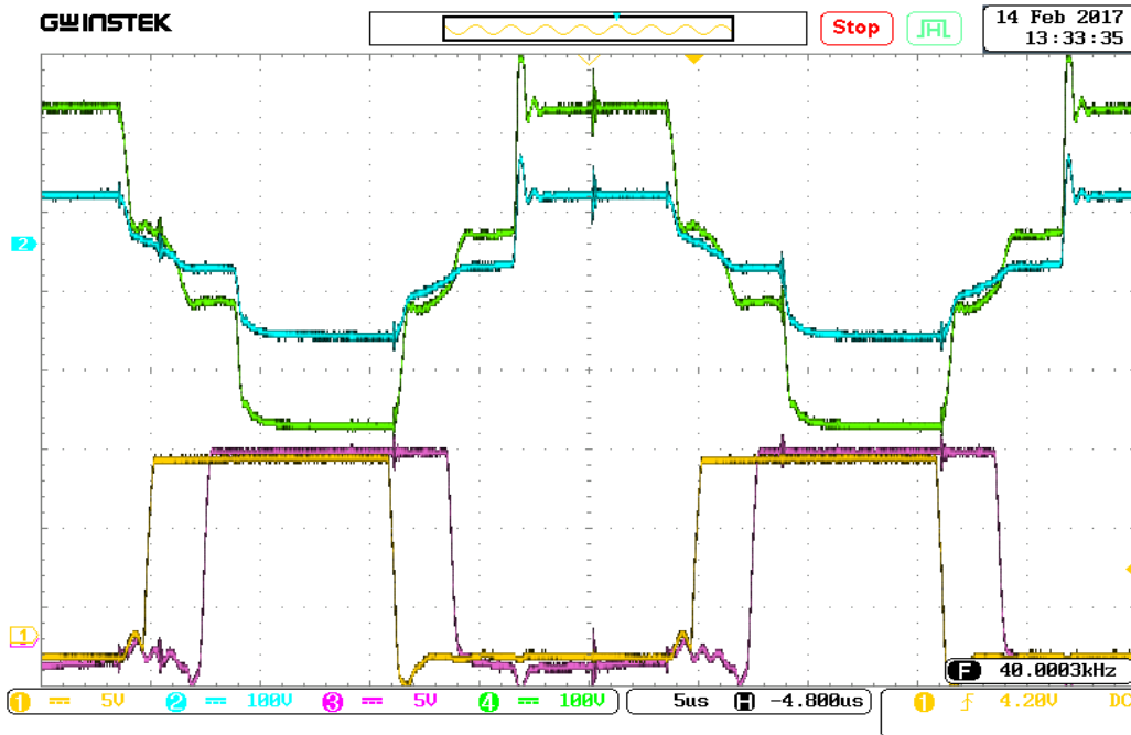
شکل (۴-۱۳): شکل موج ولتاژ دو سر اولیه ترانسفورماتور (سبز) و ولتاژ دو سر ثانویه ترانسفورماتور (آبی) به همراه پالس ارسالی به کلیدهای بازوی پیشفاز (زرد) و بازوی پسفاز (بنفش) در آزمایش نوع ۳
