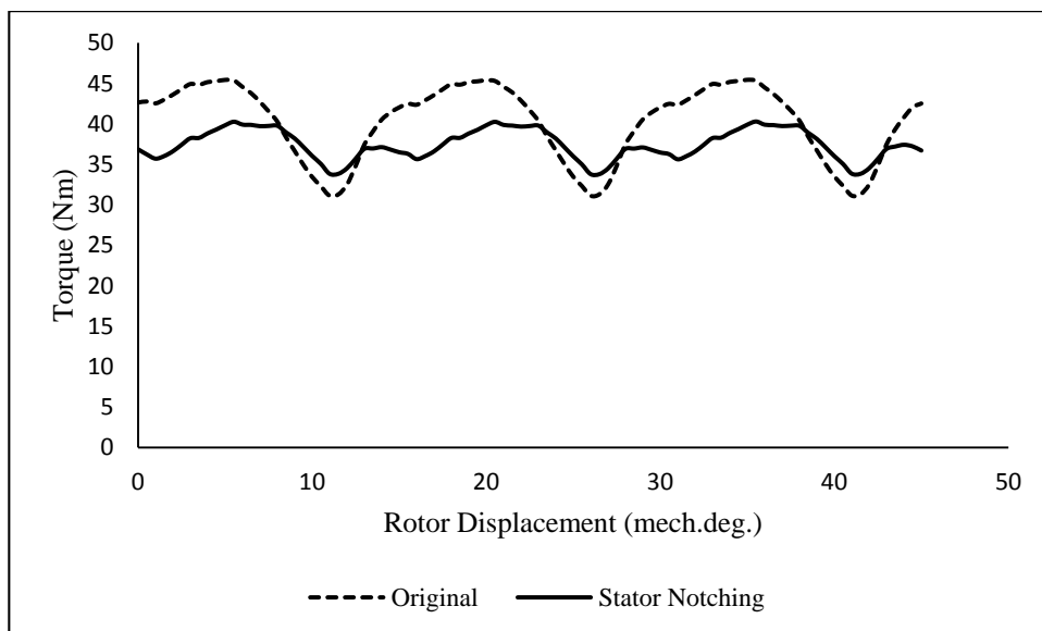
شکل (۵-۱۳): گشتاور خروجی در ایجاد دو شکاف استاتور و موتور بدون تغییر
