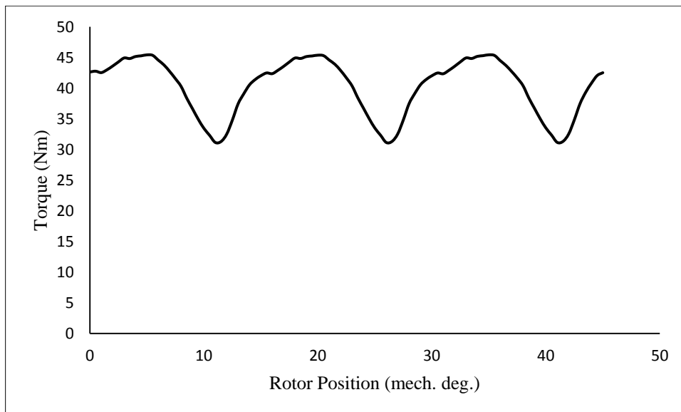
شکل (۴-۱۵): گشتاور خروجی موتور در سرعت نامی
