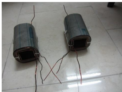
شکل (۴-۱۱) نمونه ساخته شده ترانسفورماتور کور تایپ لایه ای با مشخصات جدول (۴-۱) و (۴-۲)
