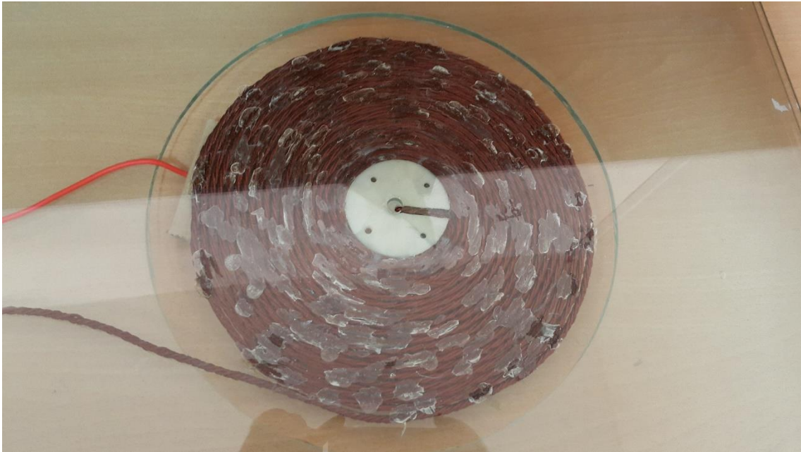
شکل ۴-۱ القاگر مورد استفاده برای گرم‌کن القایی
