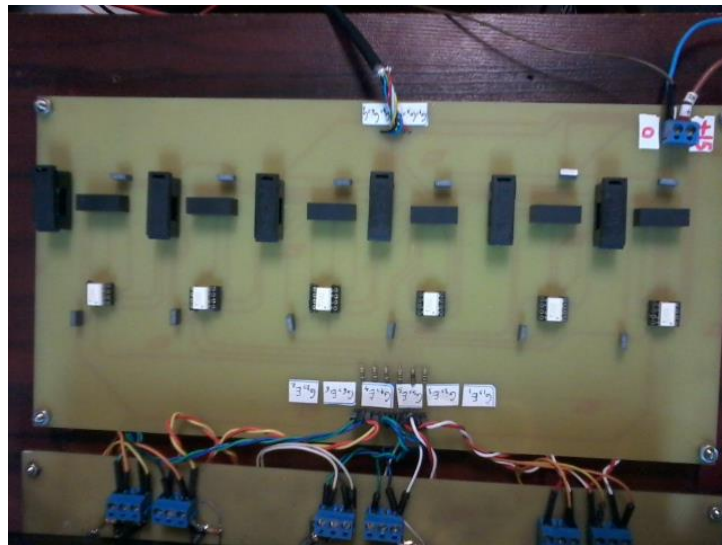
شکل (۳-۲۲) نمایی از برد مدار فرمان طراحی شده
