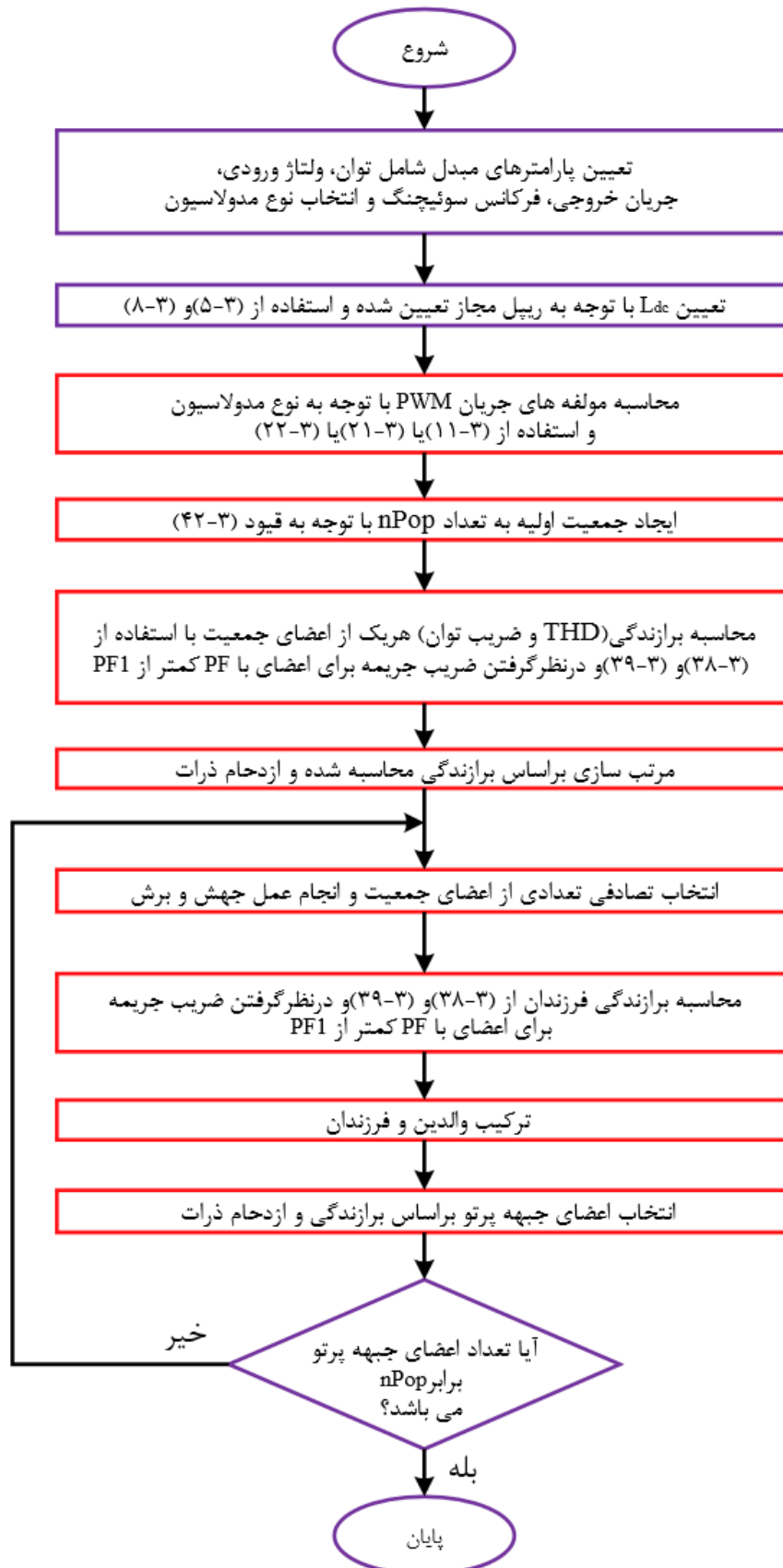
شکل (۱۴-۳) فلوچارت طراحی فیلتر ورودی و خروجی با استفاده از روش پیشنهادی
