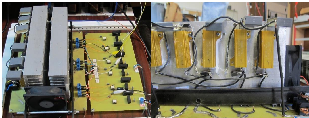
شکل (۵-۲۳) ساختار سیستم خنک‌کننده و قرارگیری مقاومت‌های اسنابر بر روی هیت‌سینک جهت خنک‌کنندگی بهتر
