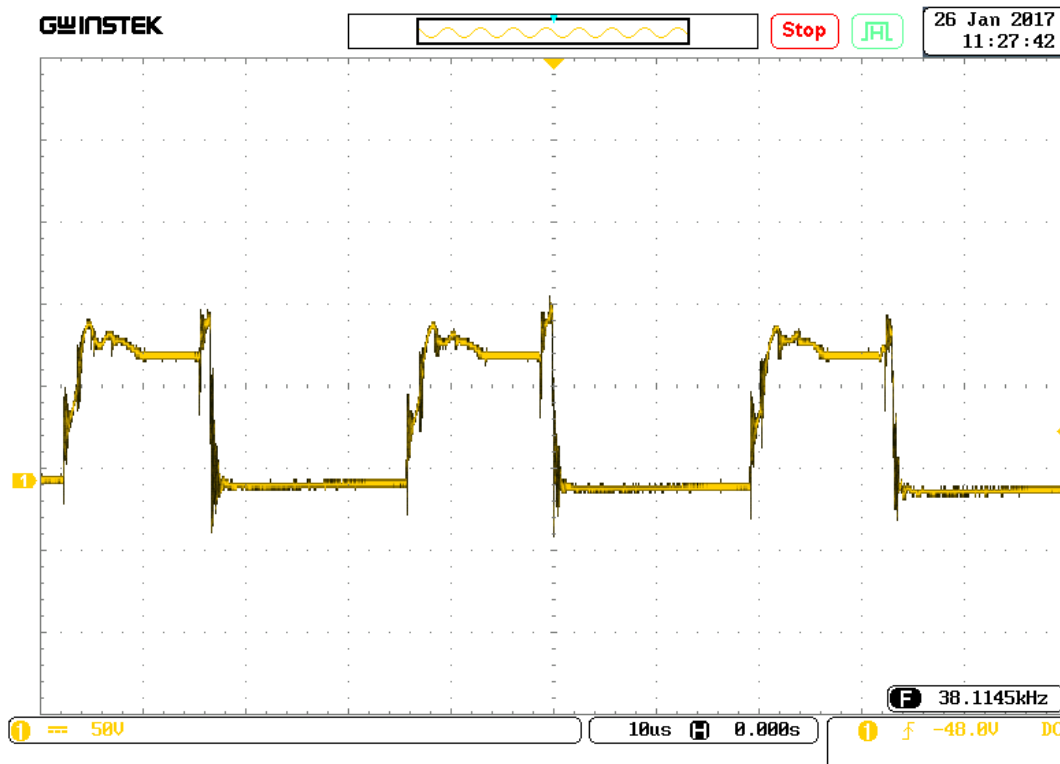
شکل (۵-۲۸) شکل موج ولتاژ دو سر کلید با اسنابر
