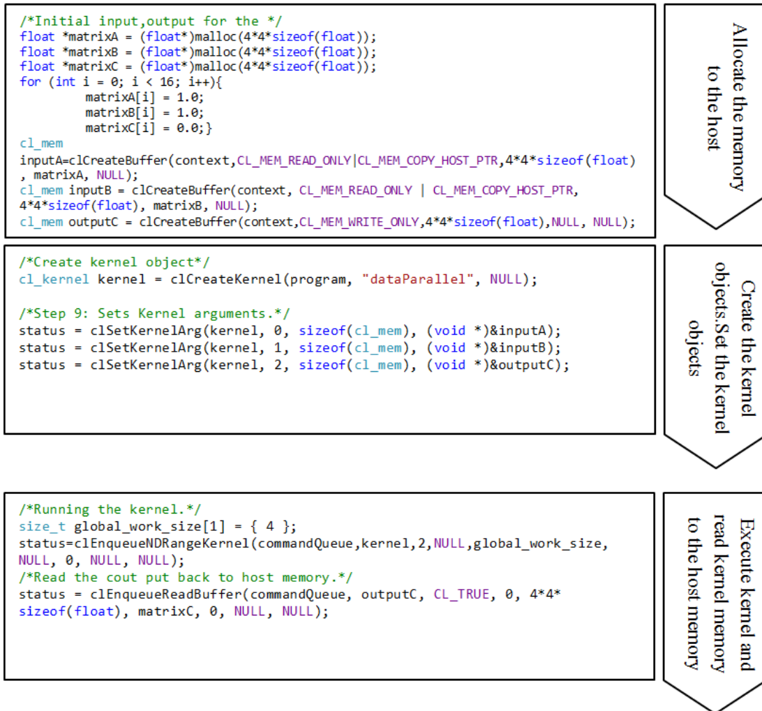
شکل ۴-۶: مثالی از مراحل لازم برای بکارگیری واحد پردازنده گرافیک در کنار پردازنده مرکزی در سمت میزبان
