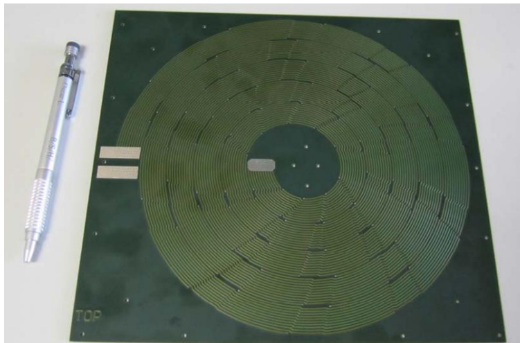
شکل ۲-۱۶: القاگر PCB در اندازه ۲۲۰mm [۱۰]
