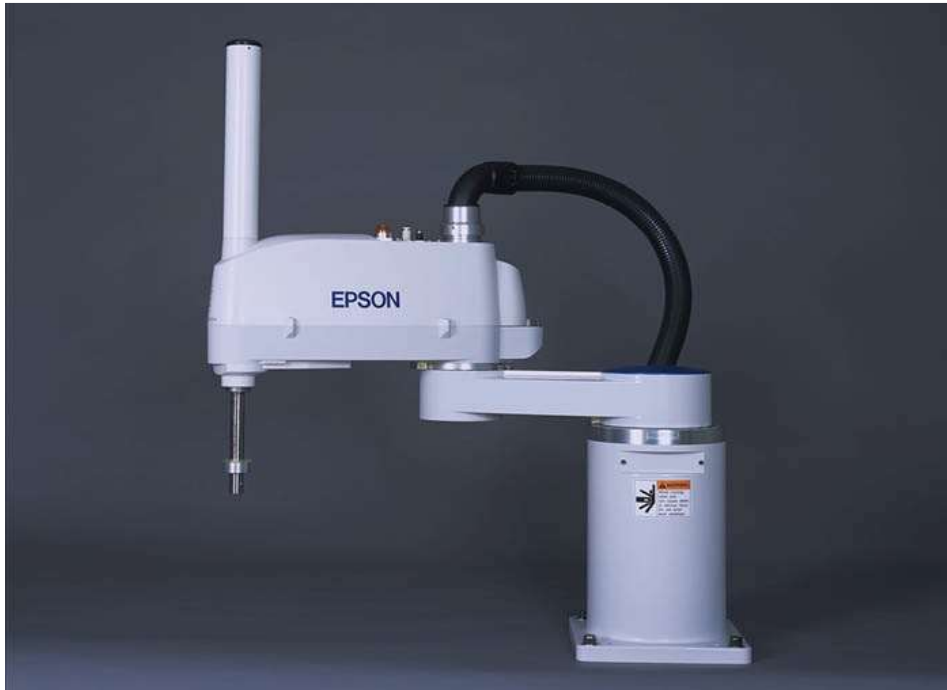
شکل ۱-۲ بازوی ربات اسکارا مدل E2L653S. [۶]
