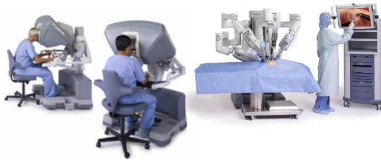
شکل (۴-۱) سیستم رباتیک از راه دور معرفی شده توسط شرکت داوینچی برای لاپاروسکوپی
