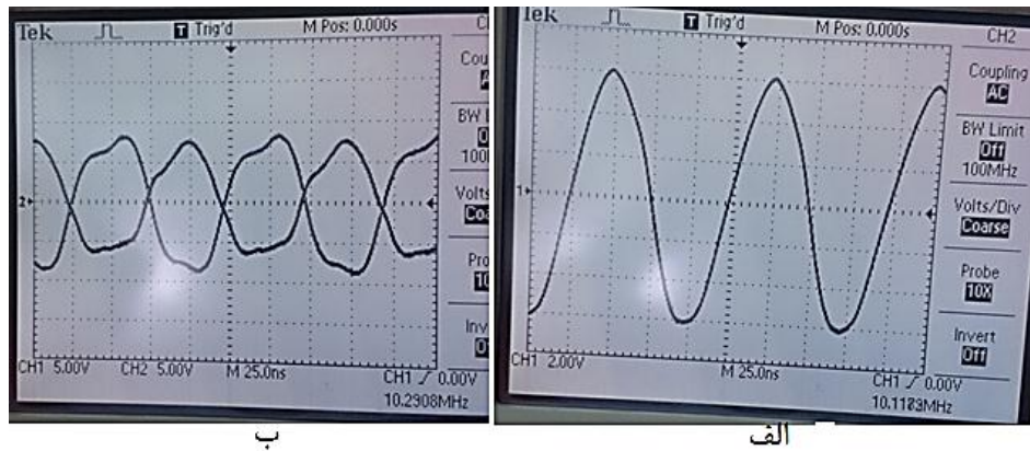
شکل (۳ - ۲۱): الف) نوسان از یک خروجی نوسان‌ساز تزویج ضربداری با دامنه بیش از ۵ ولت ب) نوسان از هر دو خروجی نوسان‌ساز
