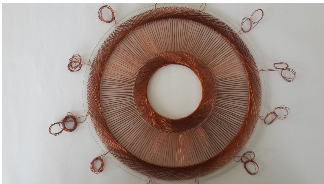
شکل ۲-۴- استاتور سه فاز شار محوری با هسته هوا
