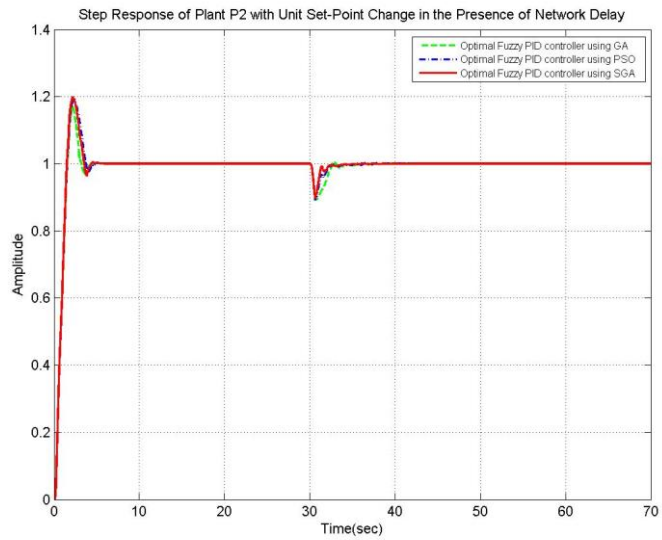
شکل (۴-۳۵) پاسخ پله دستگاہ P_2 با تغییر واحد در نقطه تنظیم در حضور تاخیر تصادفی شبکه برای کنترل کننده فازی با توابع عضویت بهینه
