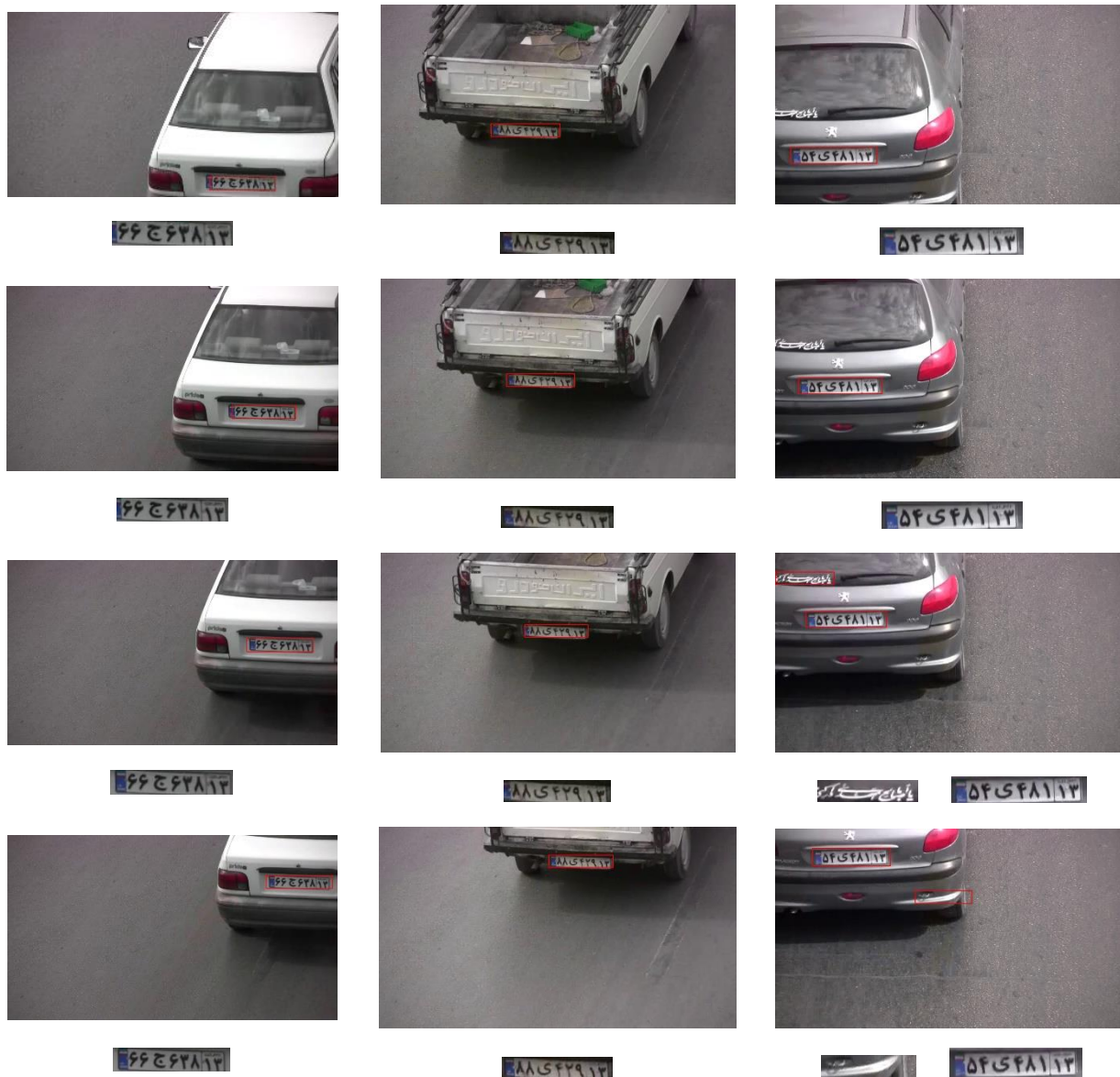
شکل ۴-۱: مثال‌هایی از آشکارسازی پلاک در قاب‌های ویدئو
