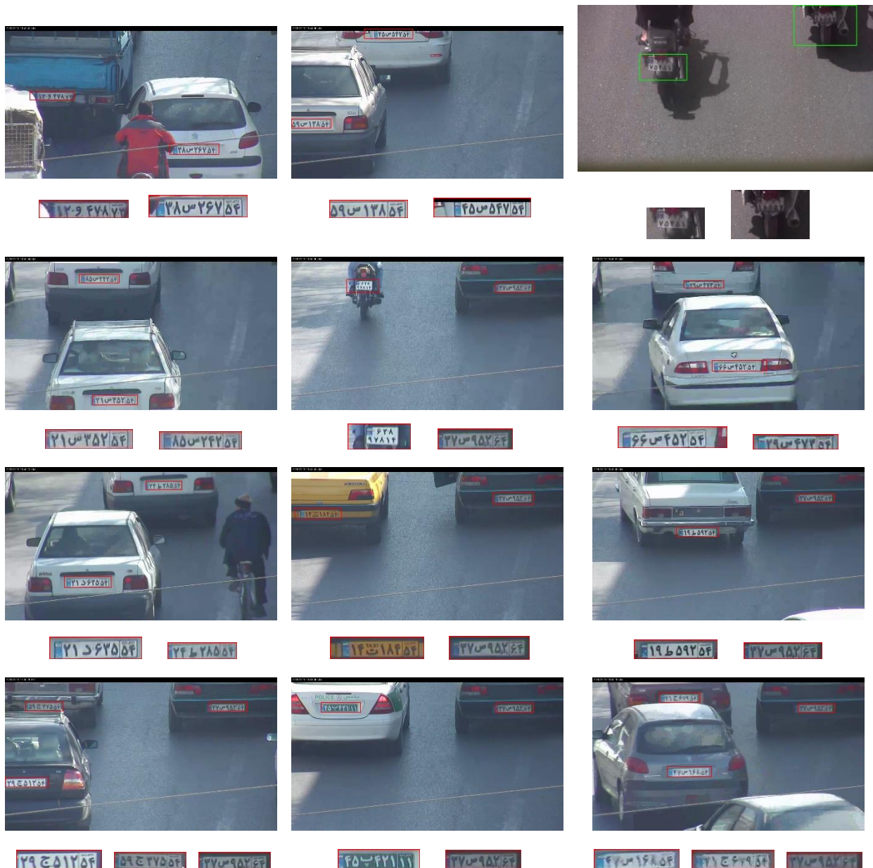
شکل ۴-۲: مثال‌هایی از آشکارسازی چند پلاک در یک قاب
