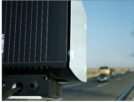
شکل ۱-۱: دوربین سامانه‌ی شناسایی پلاک خودرو
