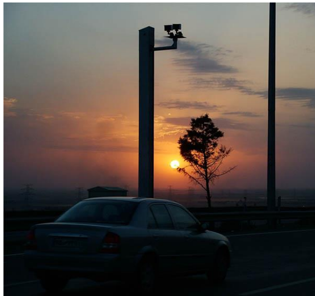
شکل ۲-۱: دوربین نصب شده سامانه‌ی تشخیص پلاک خودرو
