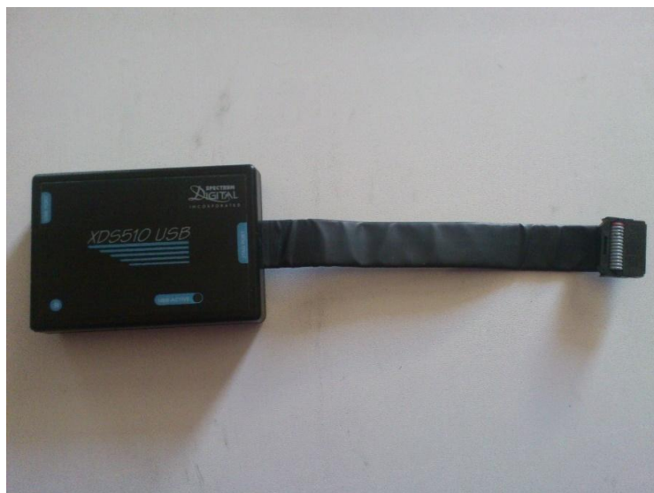
شکل (۳-۱): JTAG جهت ارتباط کامپیوتر با پردازنده DSP
