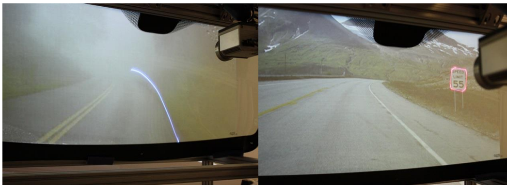
شکل (۲-۲۲): مشخص کردن اطلاعات مورد نظر در روی شیشه در HUD تولیدی شرکت GM [51]
