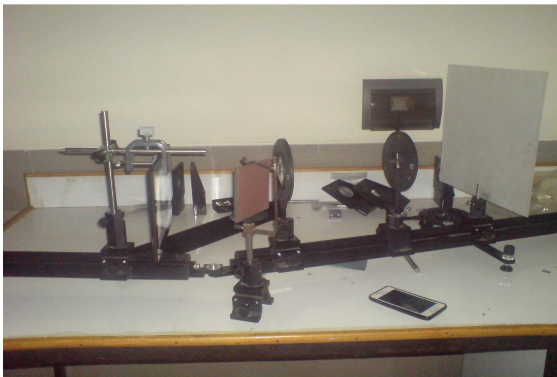
شکل (۳-۵): یک نمونه طراحی سیستم اپتیکی با لنزهای موجود در ایران
