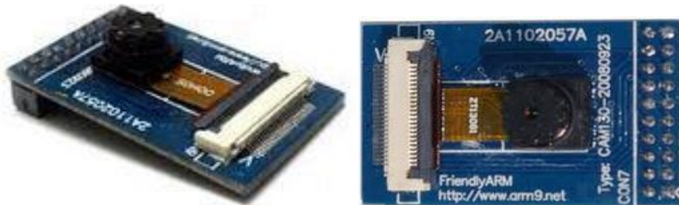
شکل (۴-۳): ماژول دوربین CMOS OV 9650
