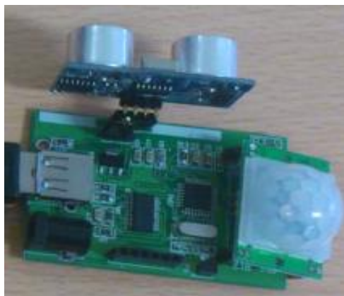
شکل (۴-۱۱): مدار دریافت اطلاعات از سنسورها
