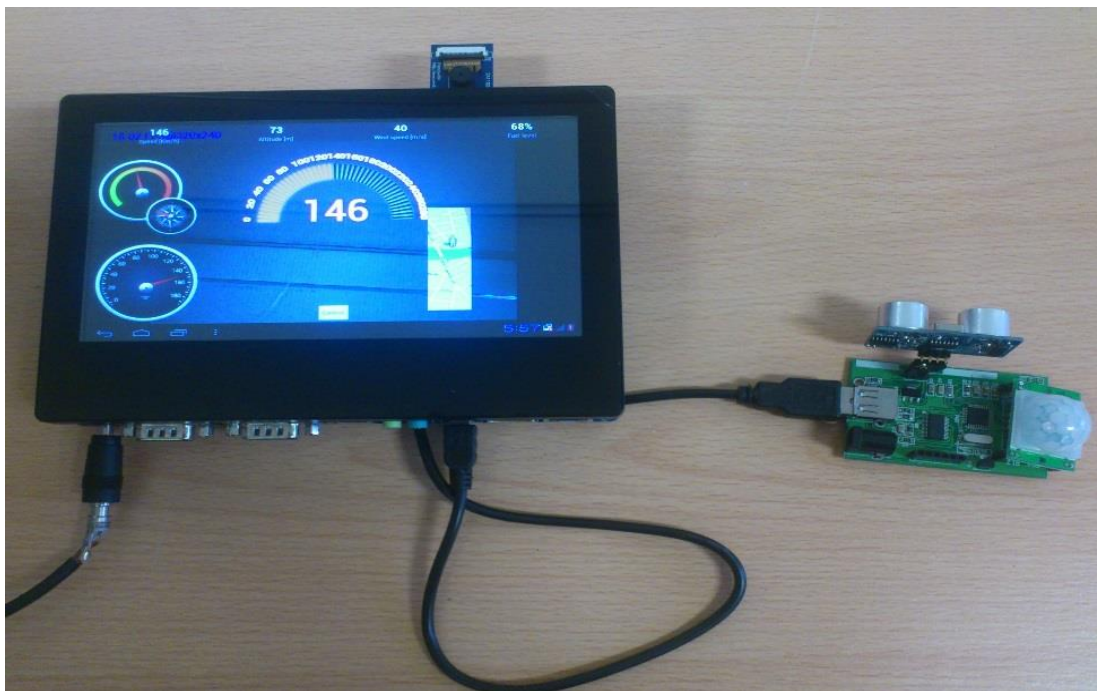
شکل (۲-۵): اتصال برد سنسورها به برد اصلی
