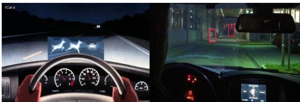
شکل (۵-۲): سیستم دید در شب در سیستم‌های نمایش HUD و HDD [23]
