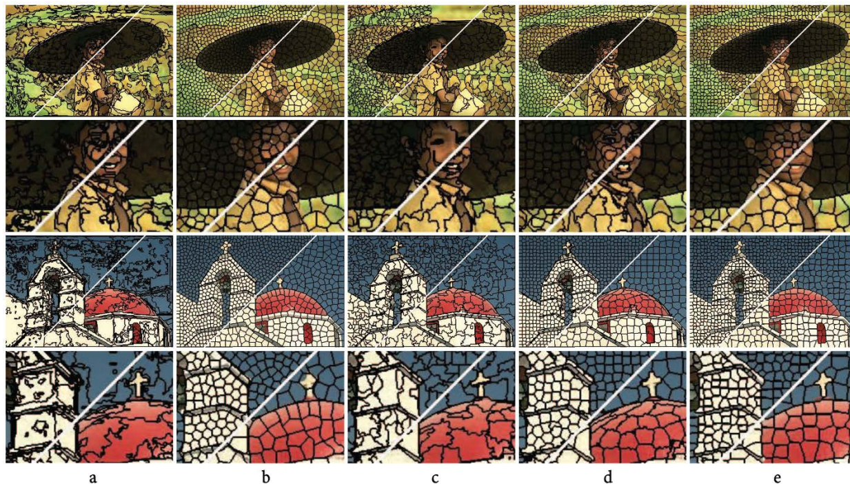
شکل ۳-۳: نتایج بصری برخی الگوریتم‌های ابرپیکسل (سری دوم [۲۴]). ستون a: الگوریتم GS04، ستون b: الگوریتم NC00، ستون c: الگوریتم TP09، ستون d: الگوریتم QS08، ستون e: الگوریتم SLIC10
