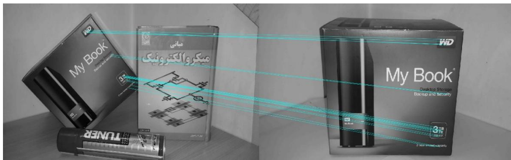
شکل ( ۴-۱ ) : حذف داده‌های پرت با استفاده از RANSAC
