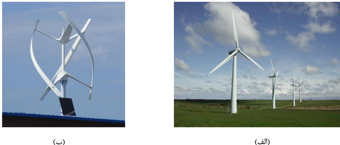
شکل (۱-۱) انواع توربین‌های بادی: (الف) محور افقی [۵] و (ب) محور عمودی [۶].
