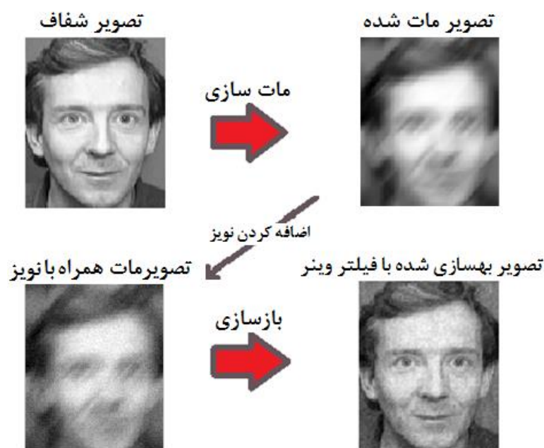
شکل (۴-۱۰): نتایج حاصل از اجرای روش پیشنهادی جهت بهسازی تصویر مات شده با عامل مات کننده ماتی بر اثر حرکت دوربین (در اینجا کاربر L = 15 , \theta = 45^\circ را به صورت تصادفی وارد کرده است).
