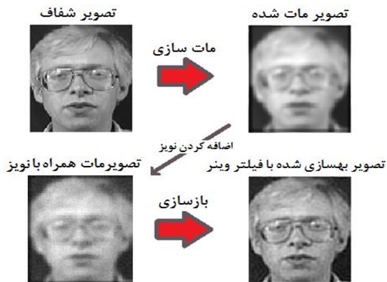
شکل (۷-۴): نتایج حاصل از اجرای روش پیشنهادی جهت بهسازی تصویر مات شده با عامل مات کننده خارج زوم بودن سوژه نسبت به دوربین (در اینجا، کاربر \sigma = 2 را به صورت تصادفی وارد کرده است)
