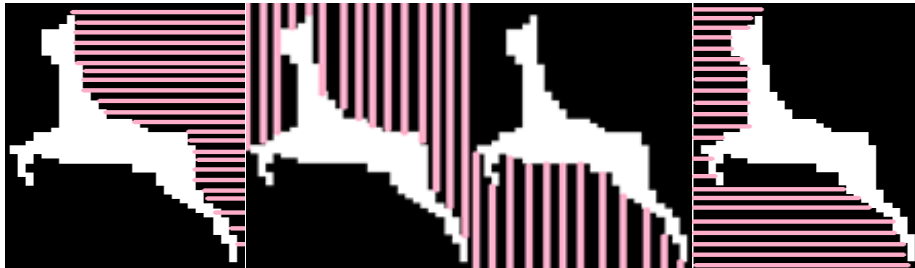
شکل ۴-۱۸: نحوه استخراج ویژگی برای شناسایی نوع دقیق علامت
