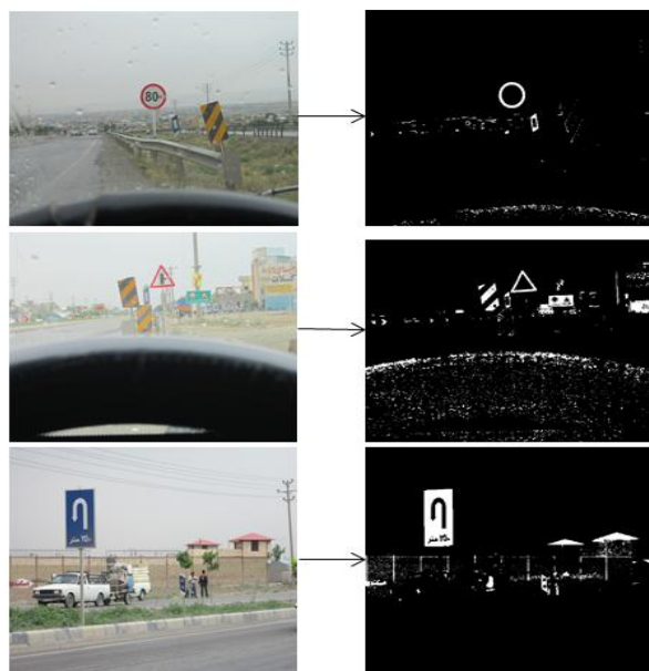
شکل ۴-۱۲: استخراج مناطق با رنگ قرمز و آبی با استفاده از منطق فازی و رفع مشکل شکل (۴-۹).
