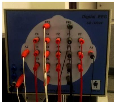
شکل (۱-۵) : دستگاه ۲۴ کاناله ضبط سیگنال مغزی
