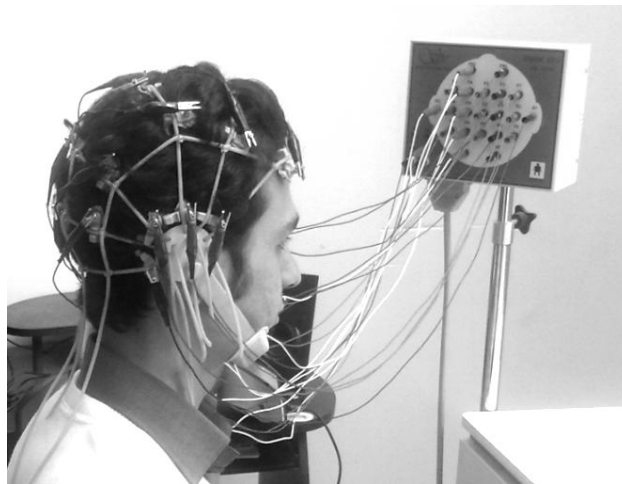
شکل (۵-۱): نصب الکترودها روی سر
