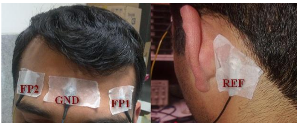
شکل (۴-۲۲): موقعیت الکترودهای نصب شده در هنگام تست سخت افزار
