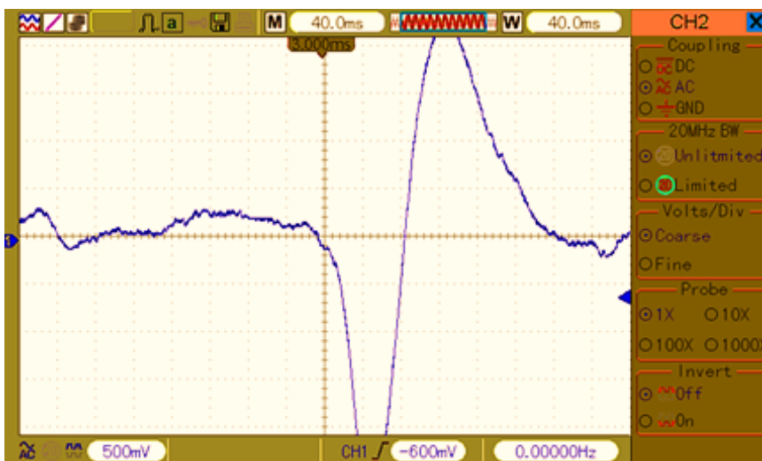
شکل (۴-۱۶): یک کانال از سیگنال‌های مغزی در حالت پلک زدن شخص توسط الکتروود روکش‌دار
